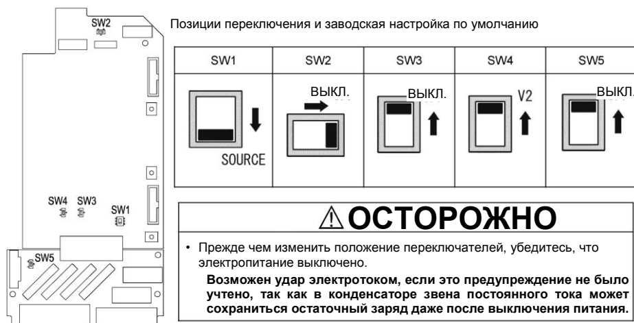
Рисунок 2.4 Расположение ползунковых переключателей на печатной плате управления
